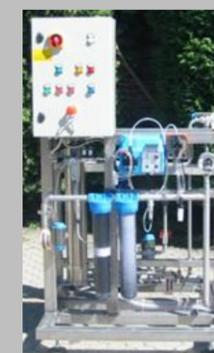
STAZIONE DI PREPARAZIONE DETERGENTE CONSENTE LA PREPARAZIONE IN AUTOMATICO DELLA SOLUZIONE DI LAVAGGIO
